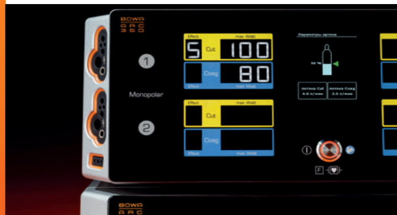
Параметры аргона устанавливаются непосредственно на ARC 350
